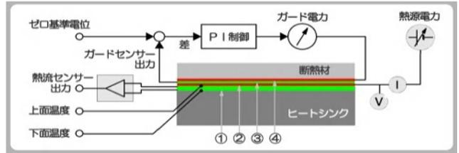
そのときの熱流センサーの出力電圧と供給電力との比から正確な「感度定数」が検定されます。
